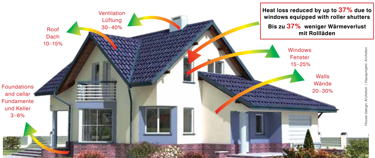
Heat losses in a building according to DAEiŚ (Lower Silesia Energy and Environment Agency). Wärmeverluste eines Gebäudes nach DAEiŚ
